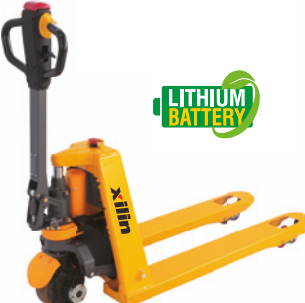
Mini electric pallet truck Model: CBD15 Cap. : 1500kg
